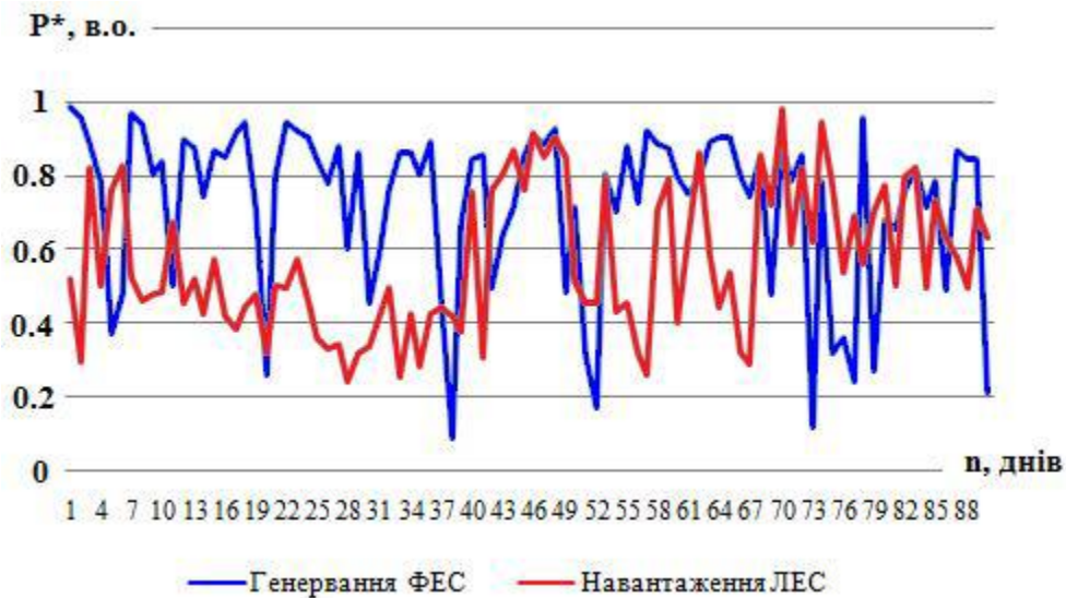
Рис.1. Зміна потужності генерування ФЕС та навантаження протягом літнього періоду в проміжок часу з 12:30 до 13:00.
