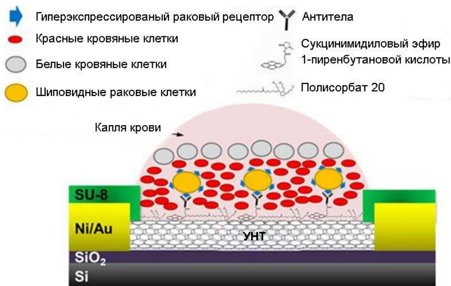
Рис.3. Схема устройства для захвата раковых клеток в крови
