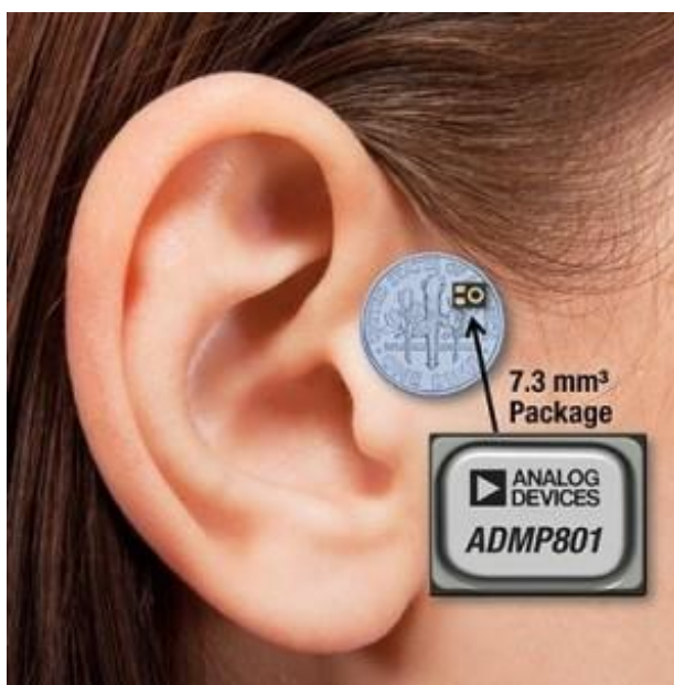
Рис. 2. Микрoфон MEMS Analog Devices для слухових апаратів.
