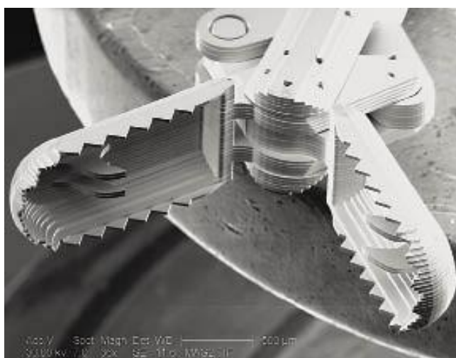
Рис.4. Микрообработанные хирургические инструменты: пара металлических щипцов для биопсии MEMS.
