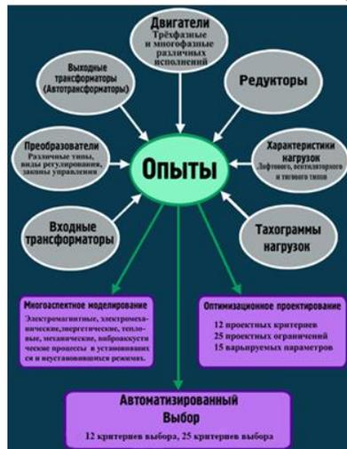
Рис. 1. Схема программы DIMASDrive
