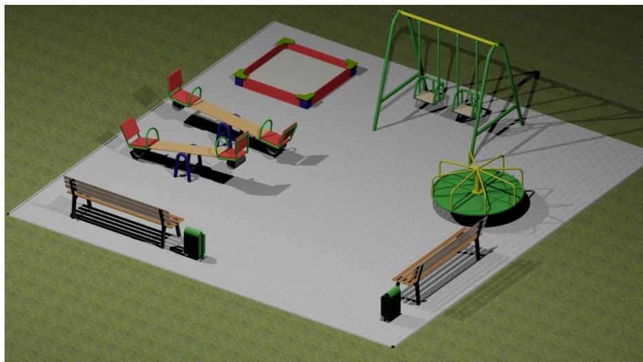
Рис. 10. Пример использования подпрограммы для автоматизированной раскладки тротуарной плитки на детской площадке
