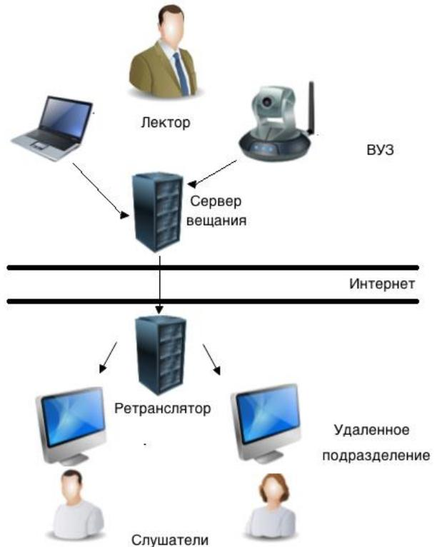
Рис. 3. Топология сети вещания с ретрансляцией в удаленном подразделении
