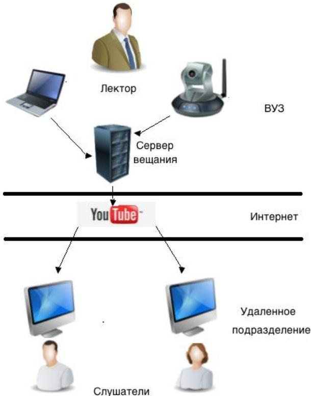
Рис. 4. Топология сети вещания с внешним центром вещания
