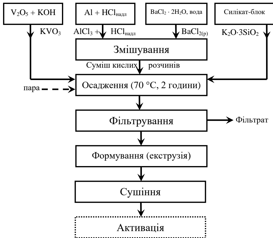
Рис. 6.3 – Схема виготовлення каталізатора марки БАВ методом осадження
