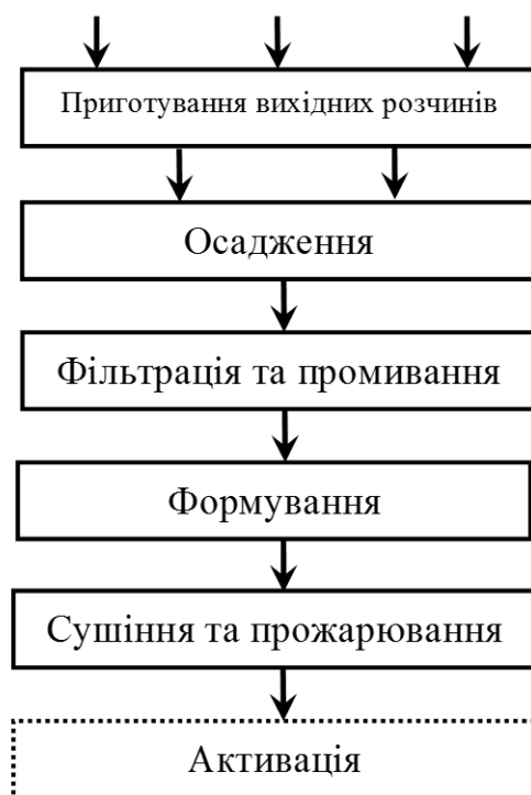
Рис. 6.2 – Схема виготовлення каталізаторів методом осадження
