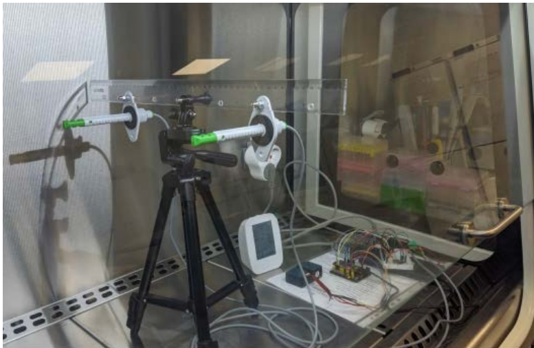
Рис. 2. Система контролю системи забезпечення якості повітря, розміщена в робочій зоні шафи біологічної безпеки 2-го класу моделі TELSTAR BIO II Advance Plus 4
