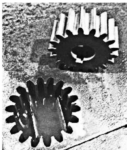
Рис. 1. Деталь, вырезанная из стали гидроабразивной резкой
