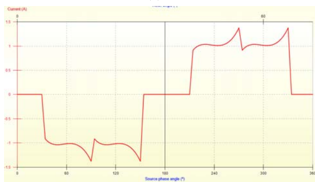
Рис. 9. Расчетная осциллограмма фазного тока ВДПМ при работе ВДПМ с нагрузкой 1 Н·м
