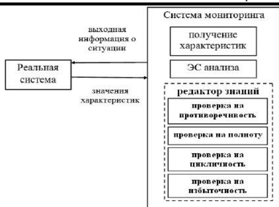
Рис. 1. Структурно–функциональная схема системы мониторинга
