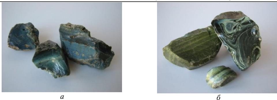
Рис. 3. Образцы шлака электродуговой плавки стали: а - с различными оттенками синего цвета; б - с различными оттенками зелёного цвета
