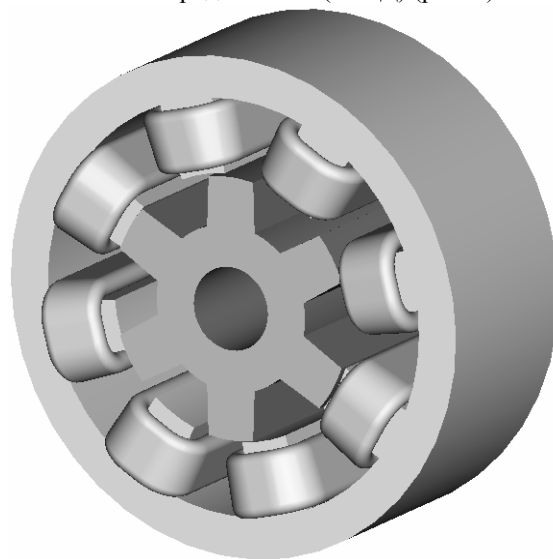
Рис. 1. Конструкция электромеханического преобразователя ВРЭД
