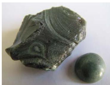
*Рис. 73. Образец шлака с выявленным после шлифовки рисунком и кабошон*
