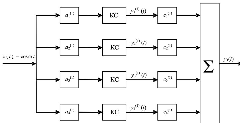
Рис. 1. Структурная схема процедуры идентификации АЧХ первого порядка.
