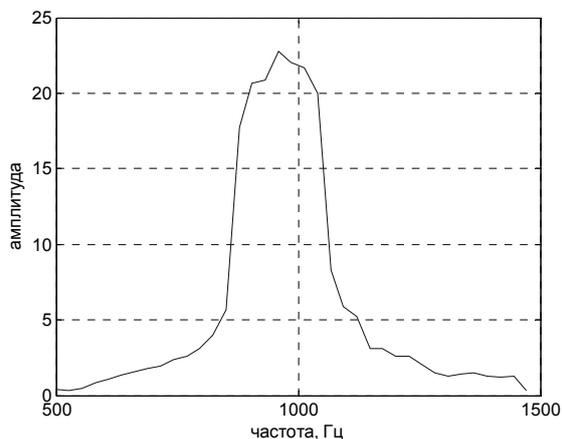
Рис. 7. Поддиагональное сечение АЧХ второго порядка после сглаживания при  $\Delta\Omega=50$  Гц.
