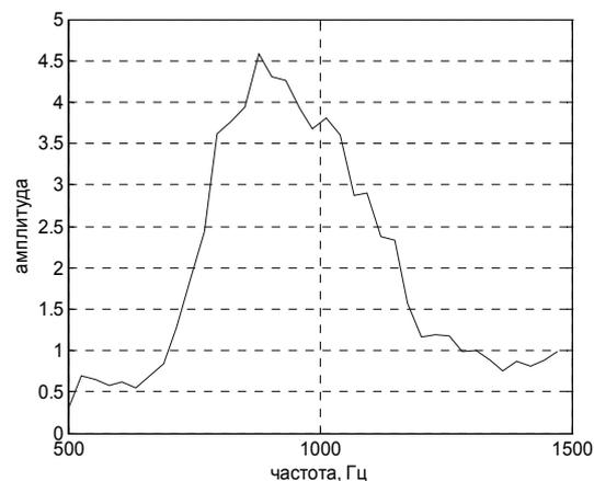
Рис. 8. Поддиагональное сечение АЧХ второго порядка после сглаживания при  $\Delta\Omega=100$  Гц.
