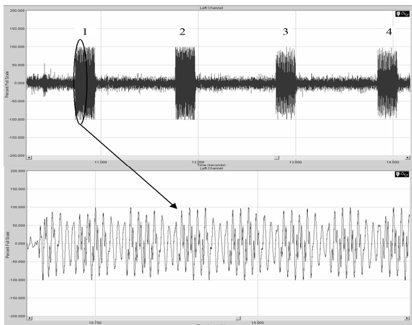
Рис. 4. Принятая группа сигналов – откликов, соответствующих амплитудам тестовых сигналов: 1 –  $a = -1$ ; 2 –  $a = 1$ ; 3 –  $a = -0,644$ ; 4 –  $a = 0,644$ .
