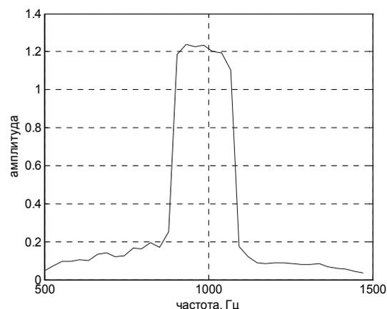
Рис. 6. Поддиагональное сечение АЧХ второго порядка после сглаживания при  $\Delta\Omega=25$  Гц.
