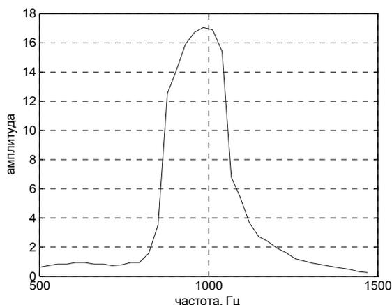
Рис. 5. АЧХ первого порядка после сглаживания.
