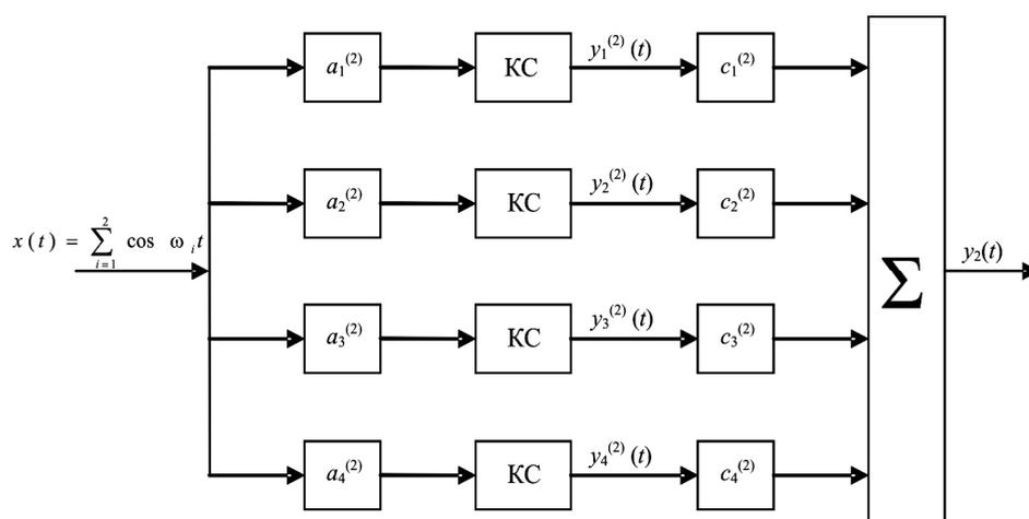
Рис. 2. Структурная схема процедуры идентификации АЧХ 2-го порядка.
