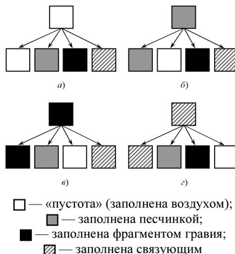
Рисунок 2 – Схема марковских переходов в состоянии ячейки модели
