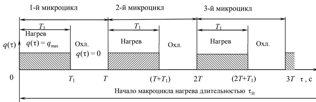
Рис. 1. Пульсирующий тепловой поток с плотностью  $q(\tau)$ :  $0T_1$  и  $T_1$  — интервалы времени нагрева и охлаждения (отсутствия нагрева), образующие микроциклы прерывистого шлифования с периодом микроцикла  $T$
