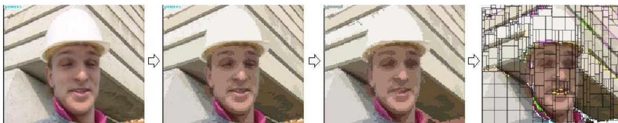
Рис. 3. Исходное изображение \Rightarrow Выделение объектов \Rightarrow Удаление шума \Rightarrow Адаптивное разбиение
