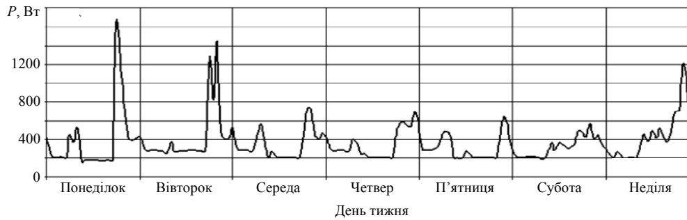
Рис. 1. Результат обробки інформації АСКОЕ щодо електричного навантаження жителя першого виду першого рівня електрифікації 10-поверхового будинку протягом тижня
