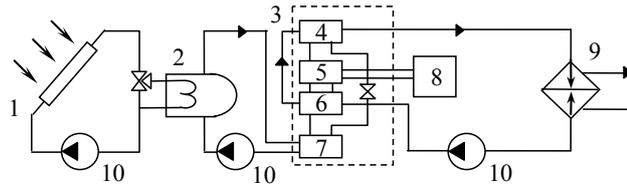
Рис. 1. Схема геліосистеми, сопряженной с абсорбционным тепловым насосом через один канал-испаритель: 1 — гелиоколлекторы, 2 — бак-аккумулятор, 3 — тепловой насос, 4 — конденсатор, 5 — генератор, 6 — абсорбер, 7 — испаритель, 8 — дублирующий источник тепла, 9 — потребитель тепла, 10 — гидравлические насосы
