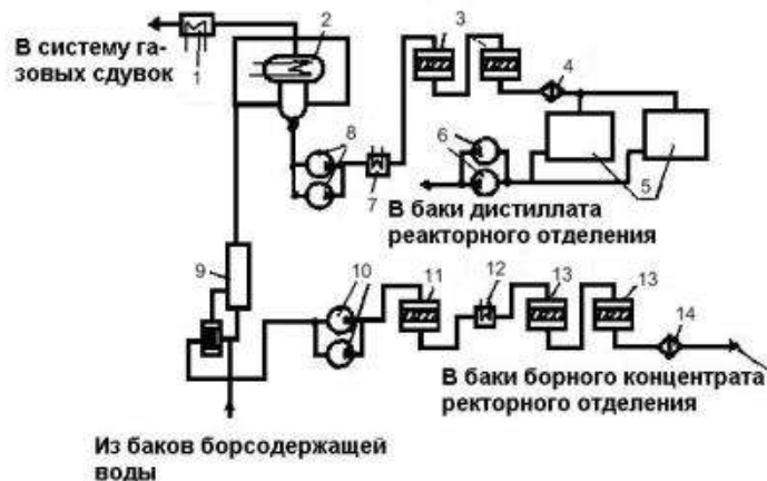
Рис. 9.15. Принципиальная схема установки СВО-6:
