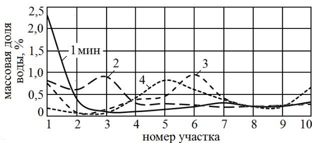
Рис. 3 – Распределение воды в песке приспособления, вращающегося в течение 1, 2, 3 и 4 минут в СВЧ-печи
