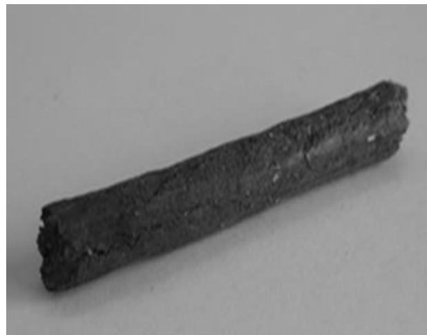
Рис. 5.44. Вид зразка пелет з опалого листа клену після екструзії
