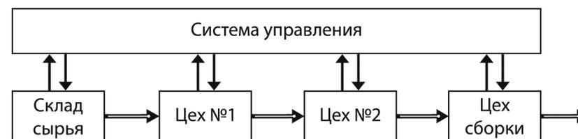
Рисунок 3.3. Принципиальная схема толкающей системы управления материальным потоком в рамках внутрипроизводственной логистической системы
