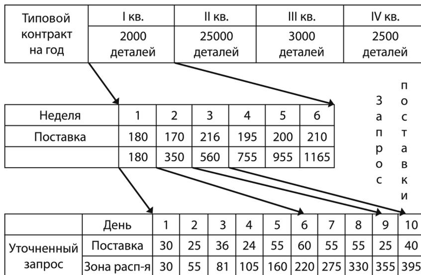
Рисунок 2.4. Система снабжения производства по запросам
