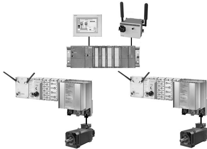
Рис. 11.7. Приклад розподіленої системи керування з використанням бездротового зв'язку
