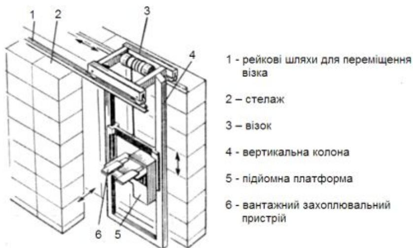
Рис. 6.5. Стелажний кран-штабелер
