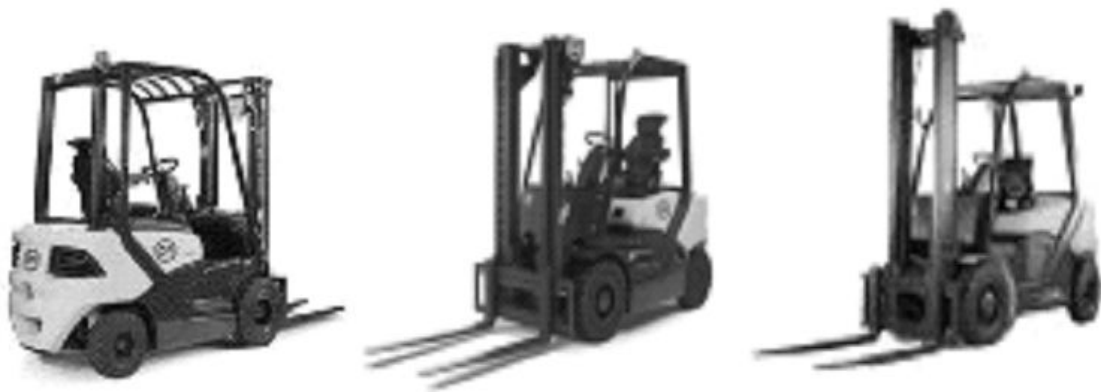
Рис. 5.2. Навантажувачі з бензиновим двигуном внутрішнього згоряння або з дизелем
