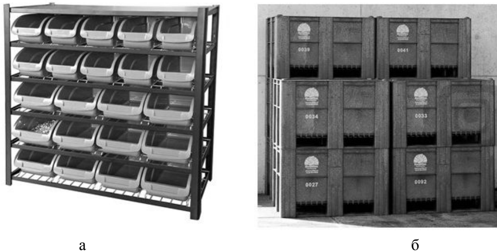
Рис. 3.10. Зберігання контейнерів на полицях (а) або шляхом штабельовання (б)
