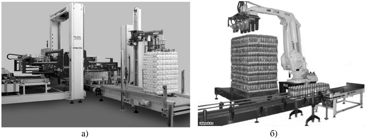
Рис. 8.1. Палетоукладчик або палетайзер у вигляді порталних машин (а) або на базі роботів-маніпуляторів (б)
