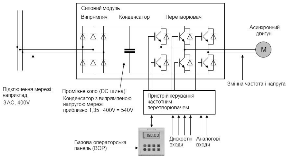
Рис. рис.22.10. Спрощена схема частотного перетворювача
