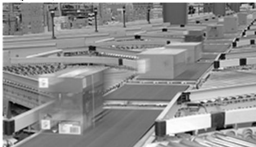
Рис. 7.2. Конвеєрне обладнання для коробок або контейнерів
