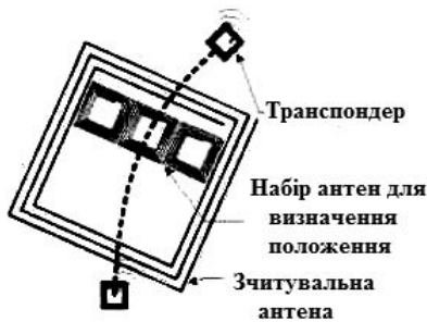
Рис. 10.10. Принцип дії транспондерів (а) та зчитувальні пристрої (б)
