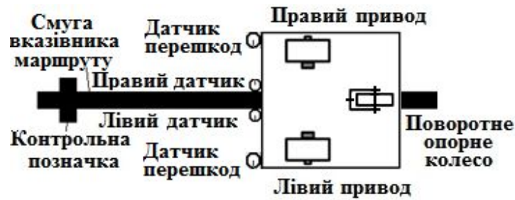
Рис. 16.8. Візок з маршрутослідкуванням за допомогою двох оптичних датчиків
