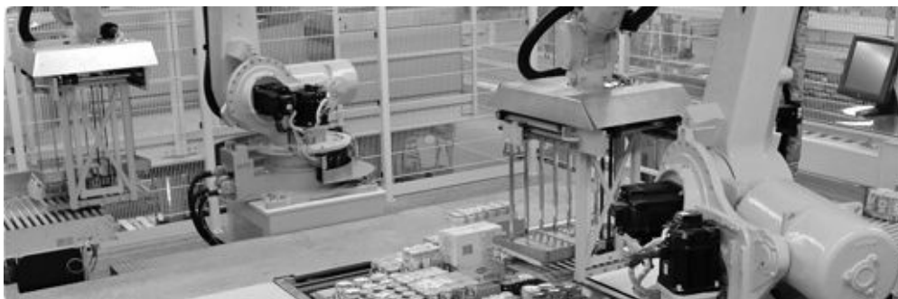
Рис. 8.6. Автоматичне палетування збірних палет
