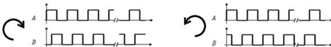
Рис. 21.4. Вихідні сигнали інкрементних оптичних енкодерів
