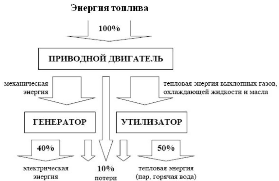
Рис. 1.1 – Структурная схема когенерационной установки
