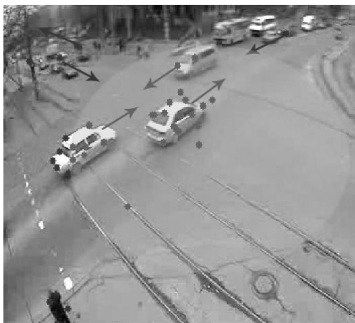
Рис. 3. Результат работы алгоритма поиск оптического потока
