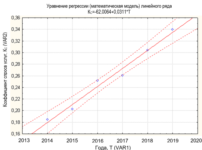
Рис. 4 График изменения коэффициента спроса услуг на выполнение уборочных механизированных работ по годам.
