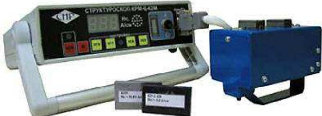
ферромагнитов. Все магнитные методы неразрушающего контроля сплошности металла основаны на обнаружении локальных возмущений поля, создаваемых дефектами в намагниченном ферромагнетике. При намагничивании объекта магнитный поток протекает по объекту контроля. В случае нахождения несплошности на пути магнитного потока, возникают поля рассеивания, форма и амплитуда которых несет информацию о размере, характере, и глубине залегания дефекта.
