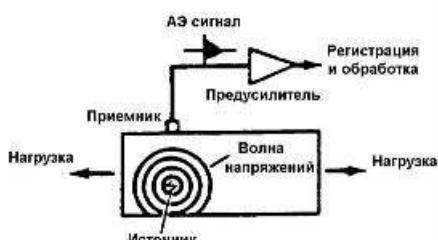
Главные источники АЭ — процессы пластической деформации, связанные с появлением, движением и исчезновением дефектов кристаллической решетки: появление и развитие микро- и макротрещин; трение (в том числе поверхностей разрывов друг о друга); фазовые (например, аллотропические) превращения в твердом теле. АЭ проявляется в виде отдельных акустических импульсов.
