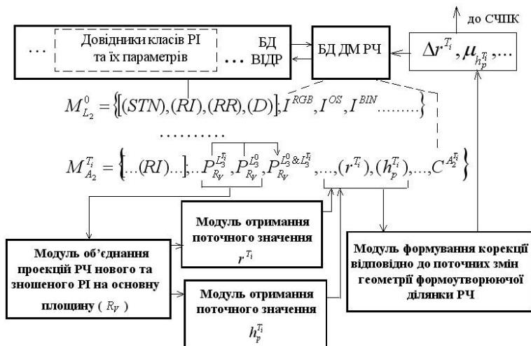
Рисунок 6 – Схематичне подання процесів оцінки поточних параметрів формоутворюючої ділянки різальної кромки, радіального зносу РІ та формування відповідних параметрів корекції для СЧПУ верстата
