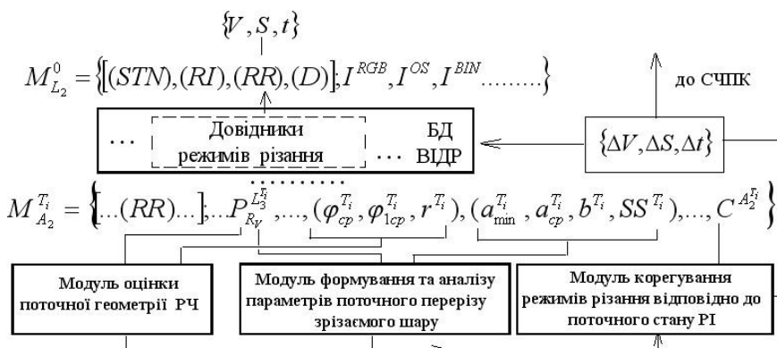
Рисунок 7 – Схематичне подання процесів оцінки поточної геометрії зношеного ПІ, параметрів поточного перетину шару, що зрізається, і формування корекції режимів різання – для забезпечення можливості подальшого використання інструменту і підвищення його залишкового ресурсу
