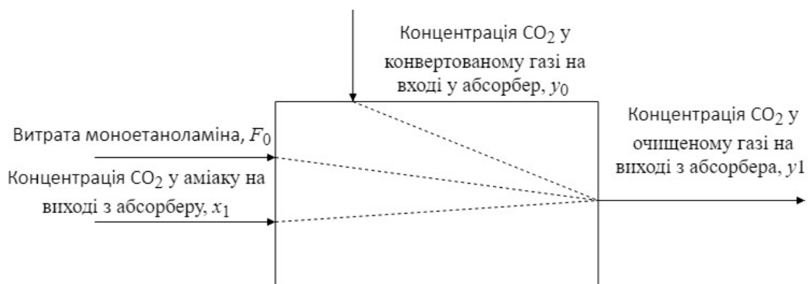
Структурно-параметрична схема абсорбера
