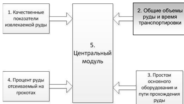
Рис. 1. Общая структурная схема прогнозирующей АСУ
