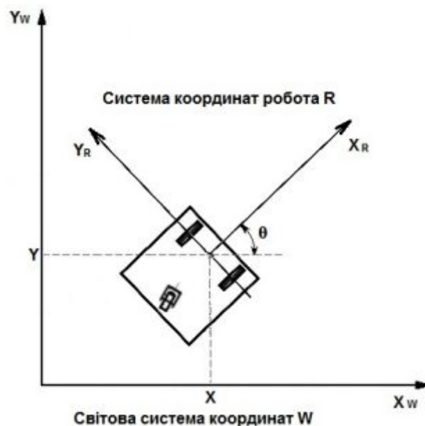
Рис. 10.19. Системи координат - світова система координат W (яка нерухома в просторі), і система координат робота R
