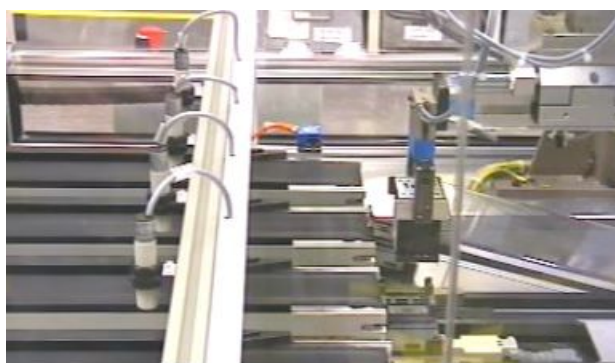
Рис. 2.6. Маніпулятор у складі технологічного обладнання
