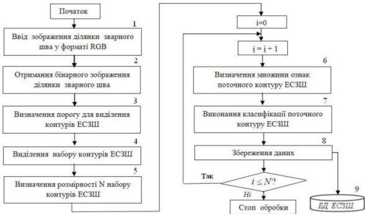
Рис. 3. Фрагмент блок-схеми алгоритму обробки цифрових зображень дефектних зон, отриманих на стенді.
