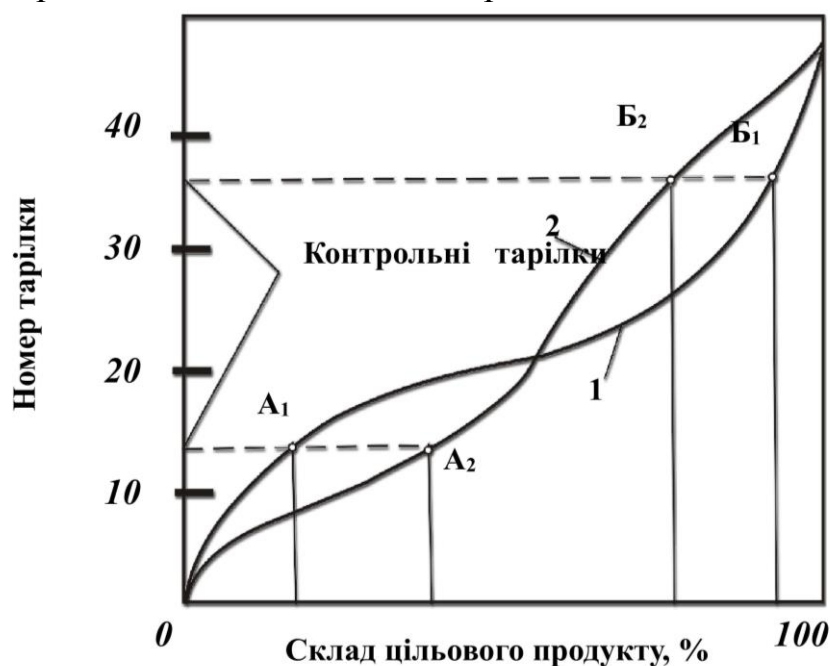
Рис. 3.32. Графік зміни складу цільового продукту по висоті колони до зміни витрати флегми (1) і після її зміни (2)
