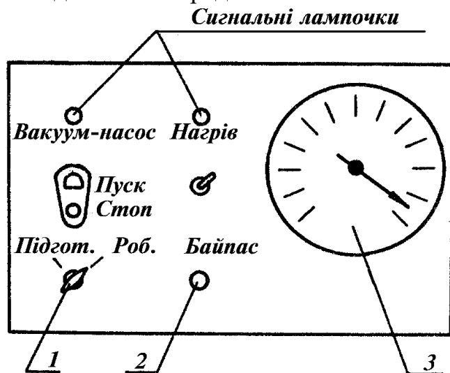
Рис. 3.3 – Схема передньої панелі блока реєстрації та управління
