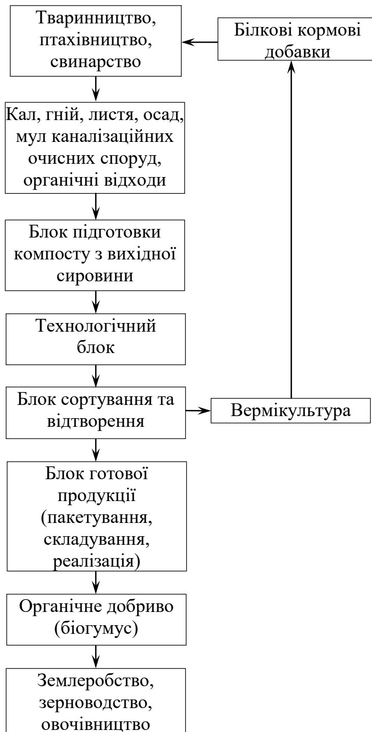
Рис. 5.9 – Схема застосування вермікультури для одержання біогумусу та кормового білка в агропромисловому комплексі
