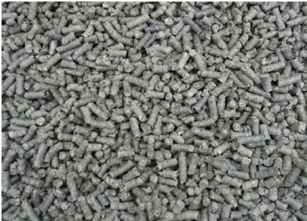
Рис. 4.8 – Загальний вигляд RDF– пеллет (фото) [39]
