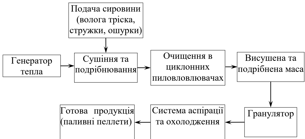
Рис. 4.9 – Технологічна схема виробництва паливних пеллет
