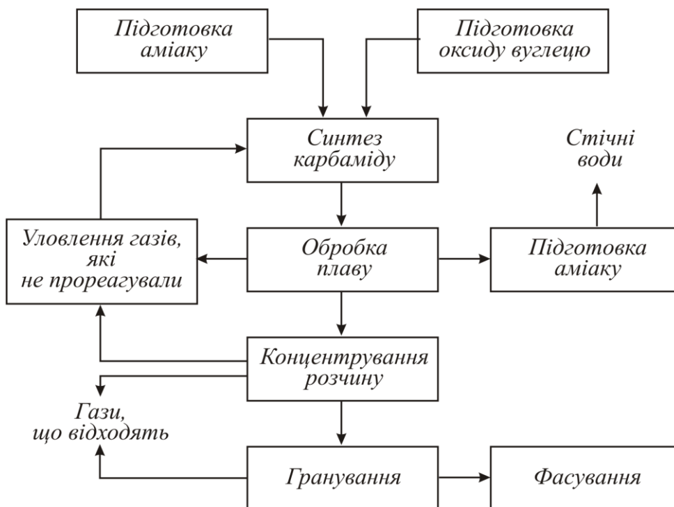
Рис. 1.1. Функціональна схема ХТС виробництва карбаміду з повним рідинним рециклом
