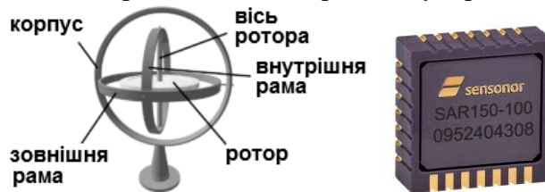
Рис. 10.8. Конструкція та зовнішній вигляд гіроскопічного датчику
