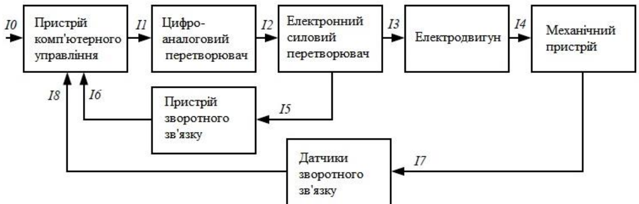
Рис. 2.3. Структура традиційного електроприводу з комп'ютерним управлінням
