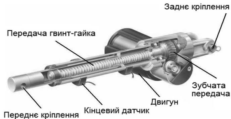
Рис. 7.12. Принцип дії лінійного актуатора
