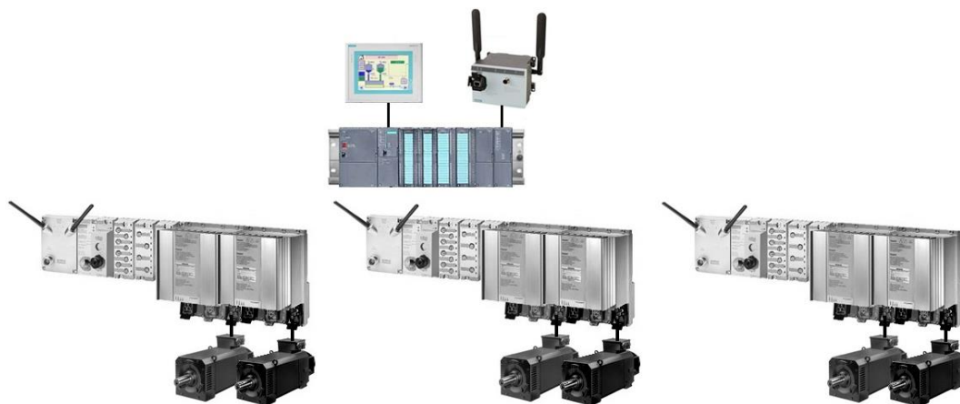
Рис. 15.8. Приклад розподіленої системи керування з використанням бездротового зв'язку
