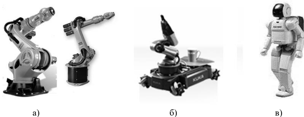
Рис. 3.4. Роботи як мехатронні пристрої: а - роботи з програмним; б - роботи з адаптивним керуванням; в - роботи з інтелектуальним управлінням
