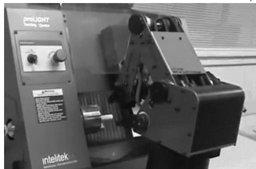
Рис. 3.7. Робот для встановлення заготовки і зняття готової деталі верстата з ЧПУ
