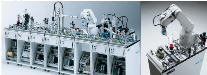
Рис. 2. Мехатронні системи навчання фірми Festo Didactic
