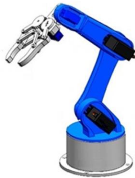
Рис. 5. Маніпулятор виготовлений за допомогою 3D-принтера
