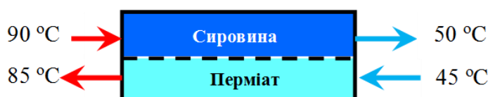
Рис. 7.12 – Принципову схему процесу мембранної дистиляції
