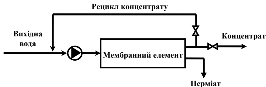
Рис. 7.9 – Принципова схема системи зворотного осмосу і нанофільтрації з рециклом концентрату
