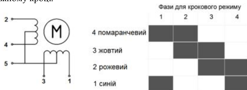
Рис.4. Послідовність подавання імпульсів для крокового режиму
