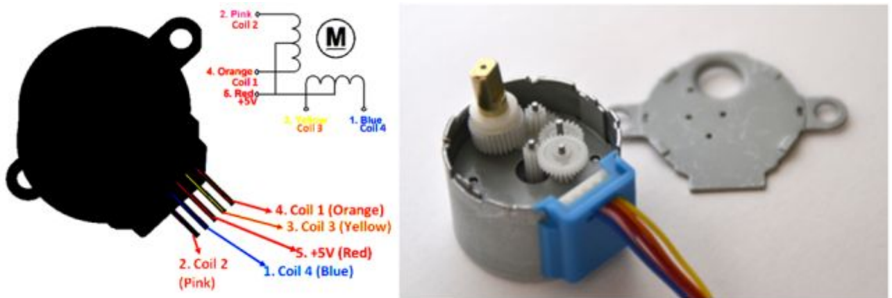
Рис.2. Підключення крокового двигуна до контролера
