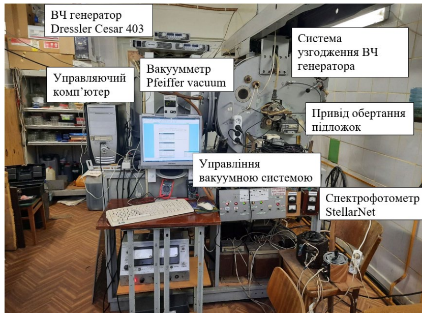
Рис. 1. Установка вакуумного напилення УВН-74
