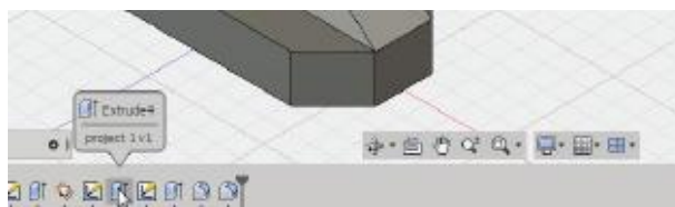
Рис. 3.2. Модифікація функції Extrude у Timeline bar
