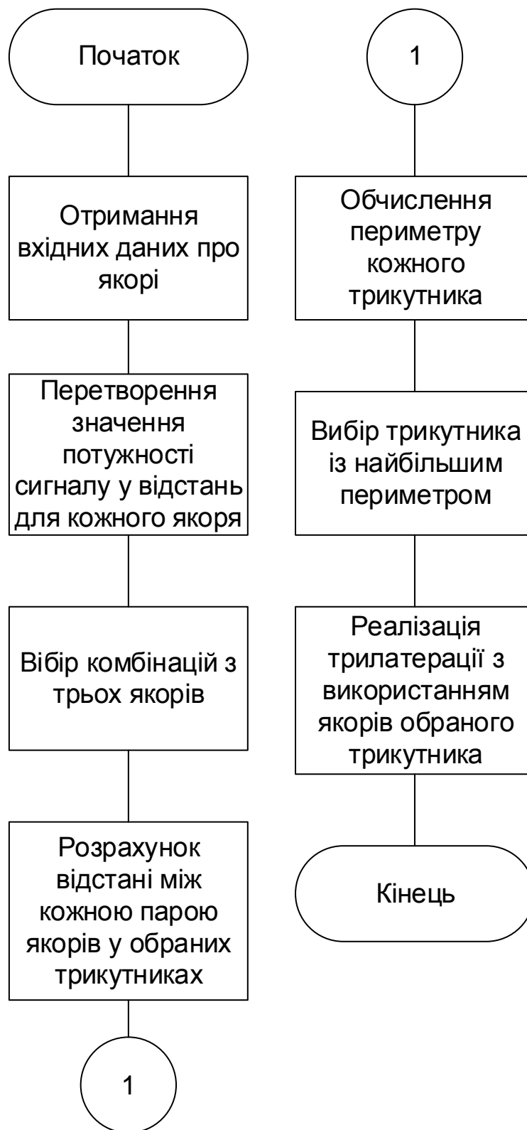
Рисунок 2.4 – Блок-схема алгоритму «Периметр»
