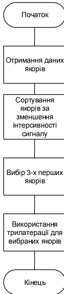
Рисунок 2.8 – Структурна схема алгоритму потужності сигналу.
