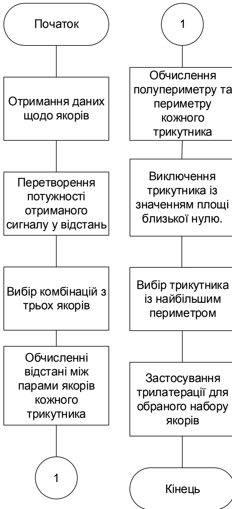
Рисунок 3.1 – Блок-схема алгоритму «Периметр-площа».
