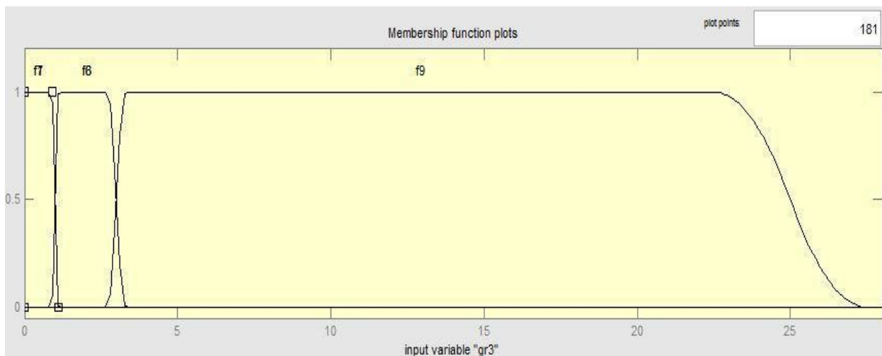
Рисунок 4.19 – Пі-подібні функції приналежності для електричного характеру дефекту для концентрацій пар газів \text{CH}_4/\text{H}_2
