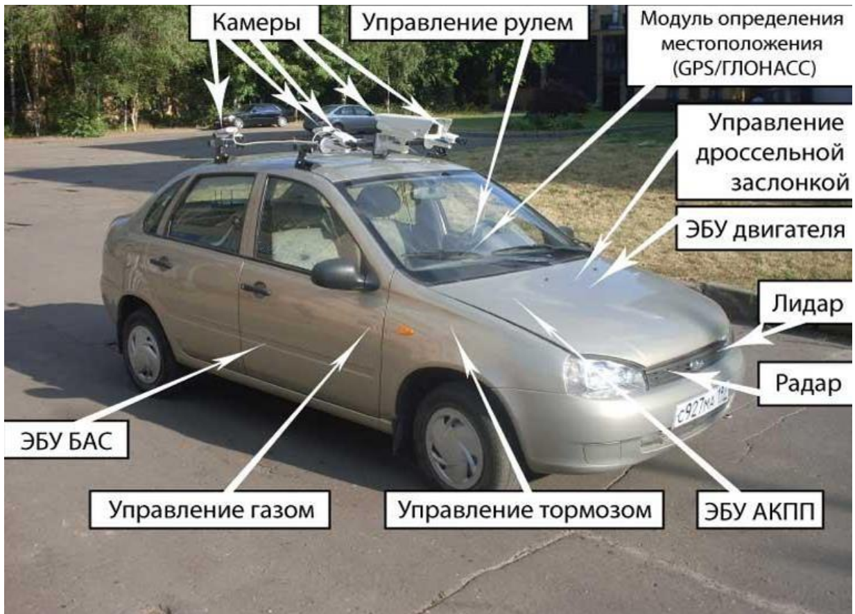
Рисунок 1.4 – Макетний зразок БАС на базі автомобіля Лада-Калина
