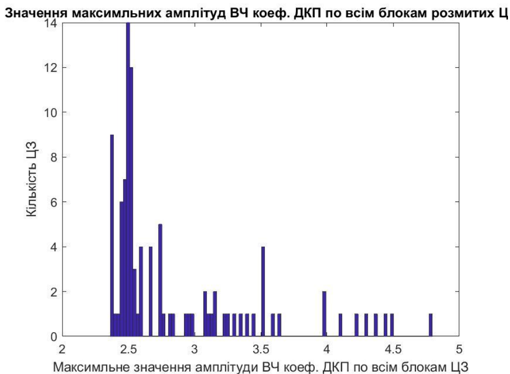
Рисунок 2.12 – Гістограма значень максимальних амплітуд високочастотних коефіцієнтів ДКП по всіх блокам розмитих ЦЗ в форматі TIF
