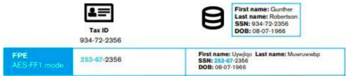
Рисунок 1.8 — Приклад FPE шифрування даних від Xmart Solutions у їх продукті Voltage Security (Hyper FPE)
