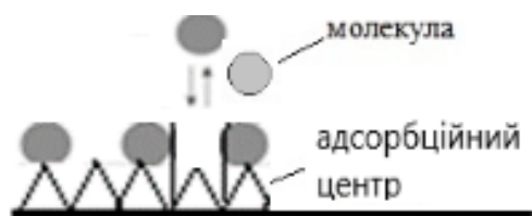
Рис. 4.1 – Формування адсорбційних шарів згідно з теорією Ленгмюра
