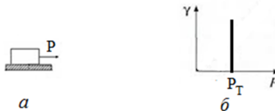
Рис. 14.3 – Модель ідеально пластичного тіла Сен-Венана – Кулона (а) та його реограма (б)
