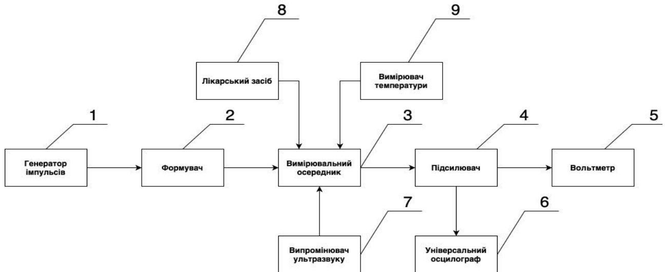
Рис. 1. Установки дозованого транспортування лікарських речовин: 1 – генератор імпульсів; 2 – формувач сигналу з комбінованими електродами; 3 – вимірювальний пристрій – осередок для біологічної структури; 4 – підсилювач; 5 – вольтметр; 6 – універсальний осцилограф; 7 – випромінювач ультразвуку; 8 – лікарський засіб; 9 – вимірювач температури.
